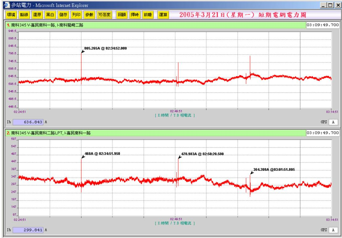
事故及事故前一段時間的故障相電流變化
