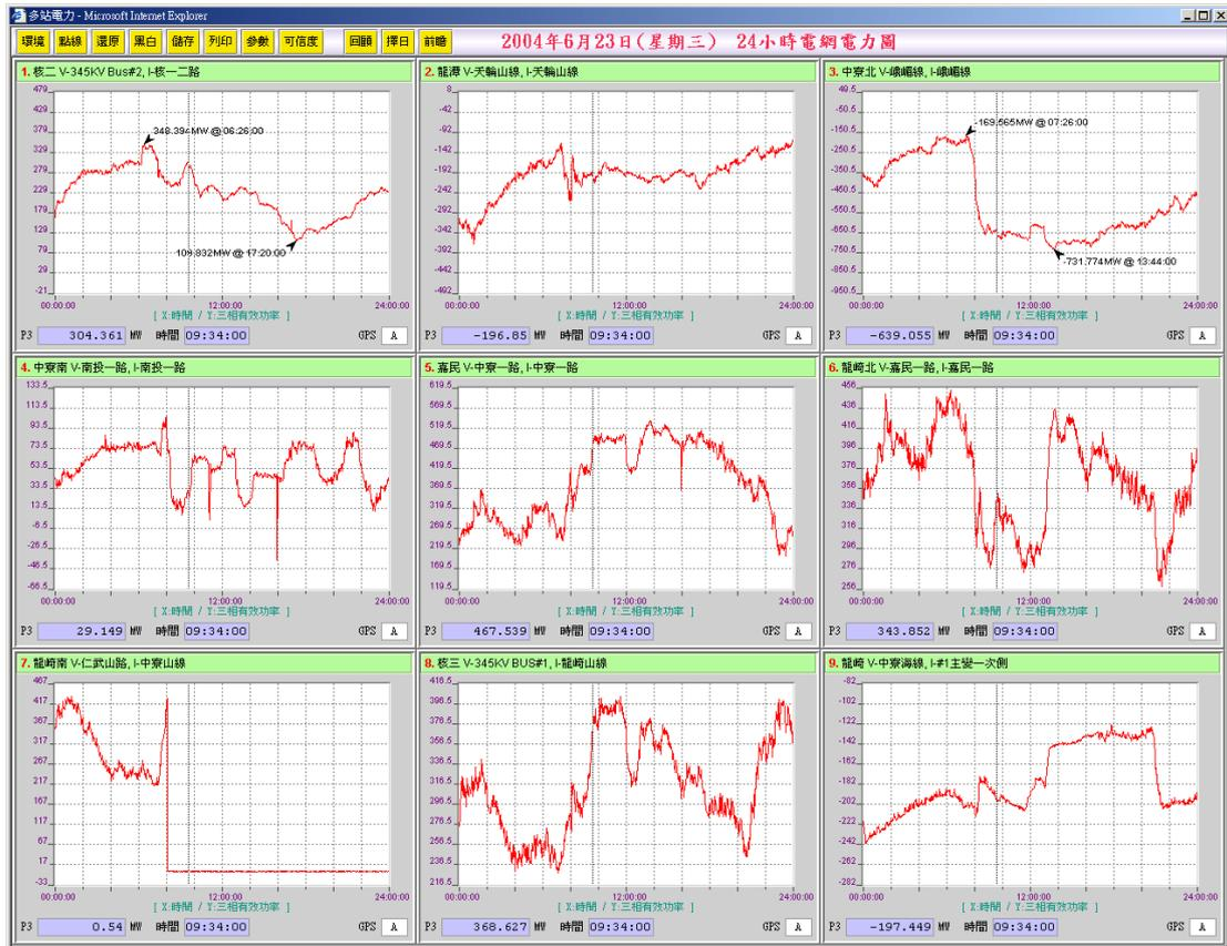
某線路停電後，南北各地的有效功率的變化
