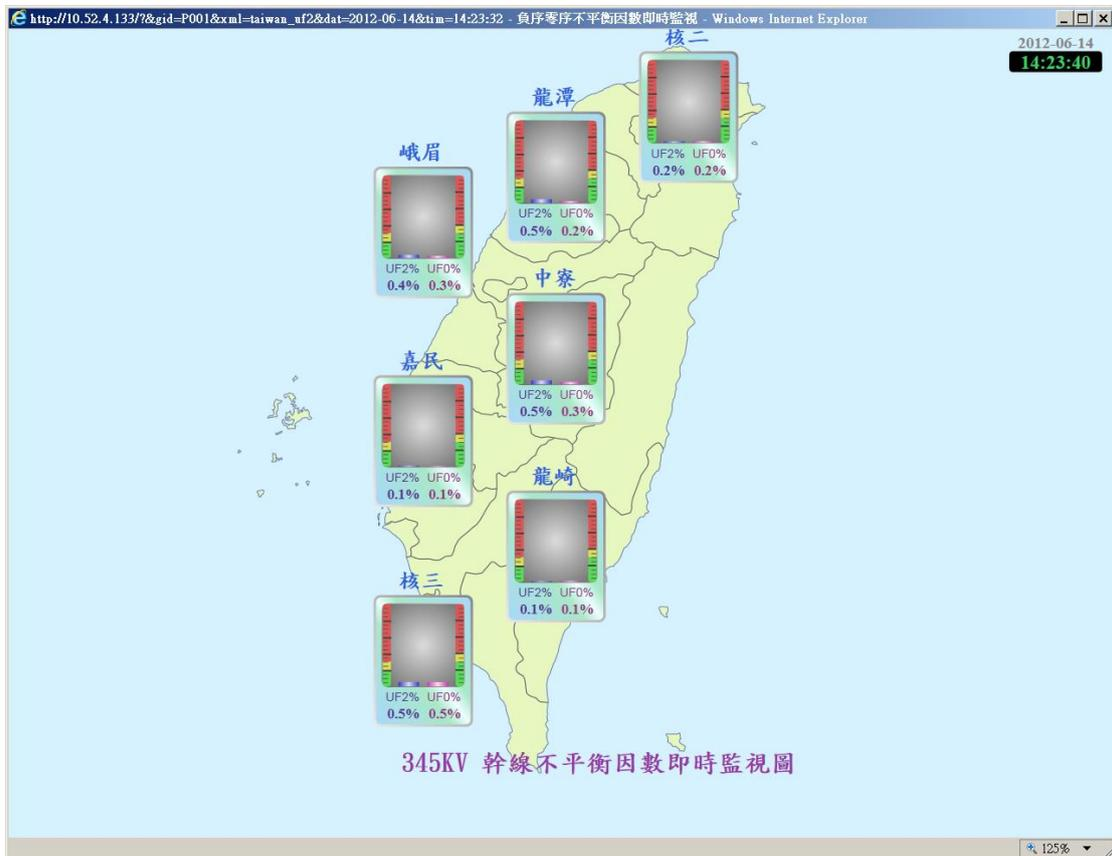
負序零序電壓不平衡因數歷史數據回放圖例
