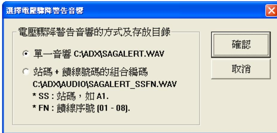
一旦現場傳回的壓降事件的錄波檔案經本系統壓降分析的結果超過壓降設限時，壓降報表會自動列印出來，同時根據站碼與饋線的不同，會發出事先預錄的警報音響檔案(SAGALERT\_SSFN.WAV)，其中 SS 代表站碼，FN代表饋線編號。換句話說、本系統 DYN32 可以因發生的地點和饋線的不同，而發出不同的壓降的警報音響。如果選擇單一音響，那麼音響的檔案就會引用到 C:\ADX\SAGALERT.WAV。
